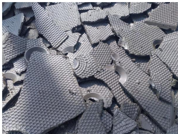
Hình 4.20. Máy ép bùn khung bản và bánh bùn sau ép
